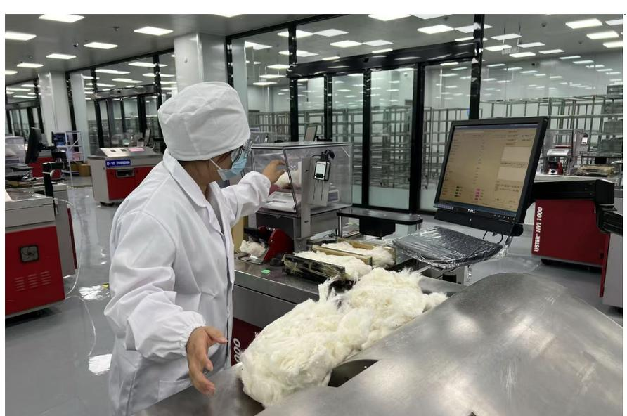
近日,工作人员通过大容量棉纤维快速测试仪对棉花的颜色级、马克隆值、长度、断裂比强度等物理指标进行检验。
